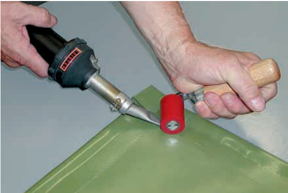
Yassı nozul takılı HOT-JET S ve baskı merdanesi ile reklam panosuna yapılan kaynak.
