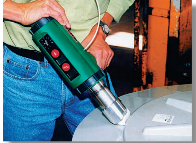
Weldmax Mini-Ekstrüder ile PP kaynağı.
