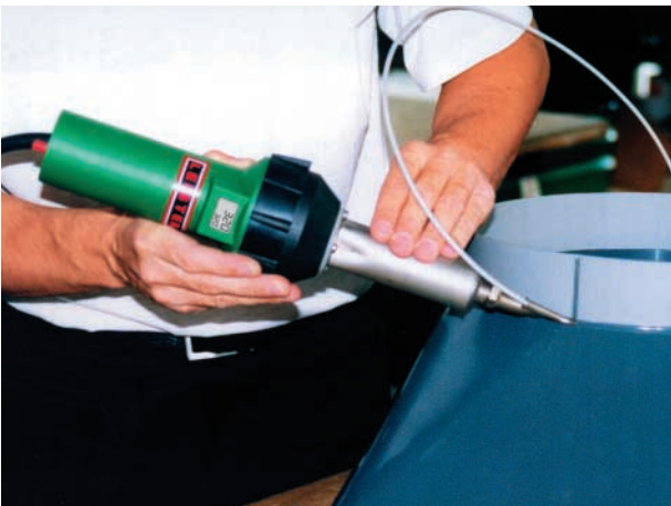
Vidalı hız kaynak nozullu TRIAC-PID. El kaynak makinası ile PVC-U kapağın kaynağı.
