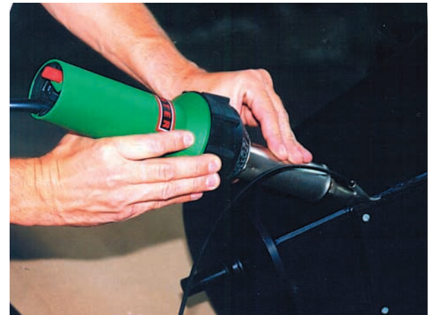
PE-HD tamburun kaynağı. TRIAC-S – Yüksek kaynak hızlı el kaynak makinası.
